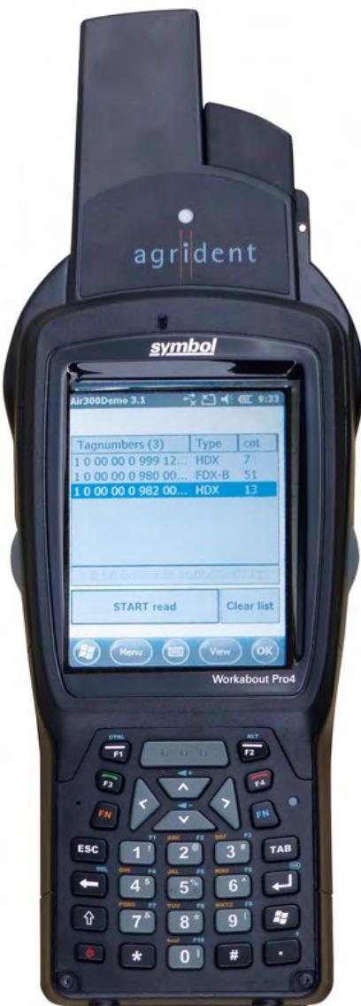
Čitač Agrident AIR 300 je mobilni kompjuter i čitač RFID elektronskih markica kompatibilan sa ISO standardom 11784/11785 i zasnovan na operativnom sistemu Windows CE ili Windows Mobile sa opcijama WiFi, GPRS, GPS i čitačem bar koda;
