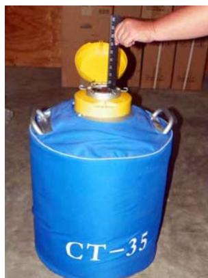
Specijalni metar, crne boje, izrađen od čvrste plastike ubacite u kontejner i sačekajte nekoliko sekundi da se ohladi.
