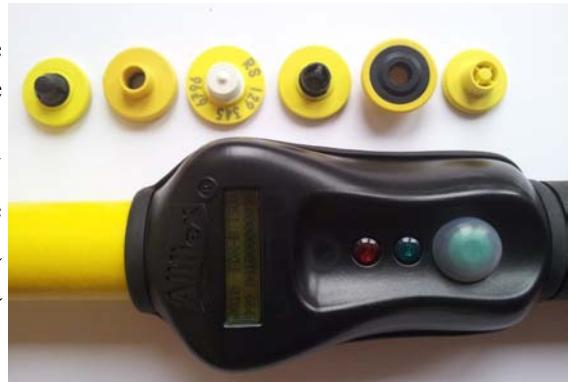
Važno je istaći da svaki čitač elektronskih markica neće dva puta očitati markicu sa istim brojem čime se onemogućava dupliranje istih zapisa. Prilikom pravilnog očitavanja jednokratni zvuk ( bip ) označava da je markica očitana a dvostruki jednokratni zvuk (bip bip ) označava da je ušna markica već očitana.
